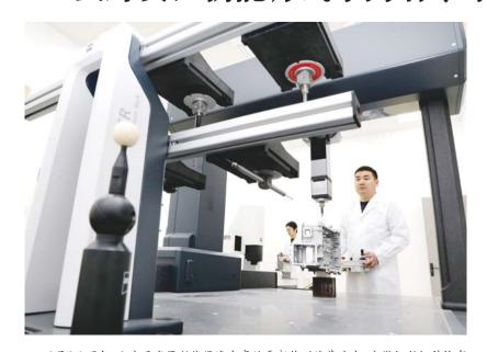
3月5日下午, 六安开发区新能源汽车高端零部件测试基地内, 安徽凯斯汀科技有 限公司试验室主管吕明操作三坐标测量仪对新能源汽车电控壳体进行精密测量。
